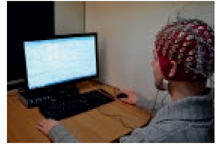
Die Elektrodenhaube misst Hirnströme über die Spannung auf der Kopfhaut.
